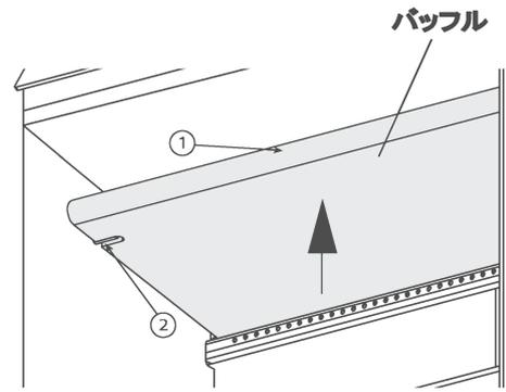
※外す際は、バッフルを持ち上げ(①)、ピン(②)を外してから取り外してください。割れやすい素材の為、取外す際は十分注意しながら行ってください。
